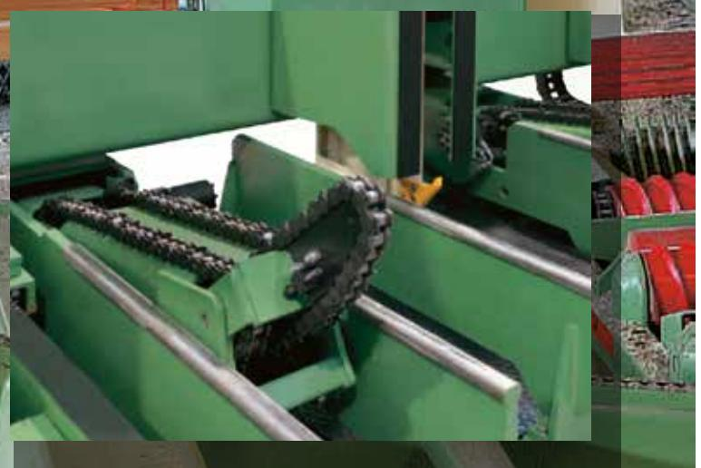
**КАНТОВАТЕЛЬ БРЕВЕН** с двойным шарниром, состоящий из двух независимых рычагов с гидравлическим подъемом. Оснащен тремя цепями с приводом от двигателя, с вращением по часовой стрелке и против часовой стрелки и с наклоном до 90°. Отлично подходит для любых типов бревен и для кантования обрезных досок без повреждения углов.
