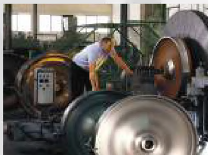
Tornitura di un volante, che poi sarà equilibrato dinamicamente Mill of a flywheel, to be dynamically balanced afterwards Formärehen einer Bandsagenrolle mit darauffolgender dynamischer Auswuchtung Façonnage d'un volant, qui sera ensuite équilibré dynamiquement Токарная обработка маховика, который затем проходит динамическую балансировку
